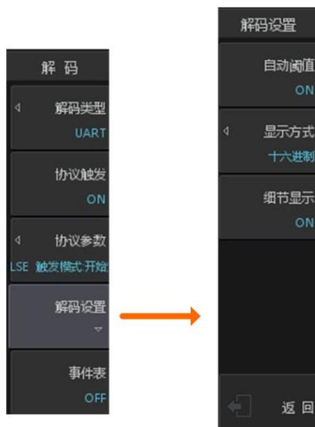
图 10.4 设置解码功能参数
