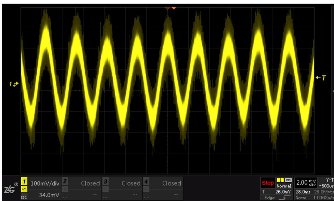
图 11.26 电源芯片输出波形
