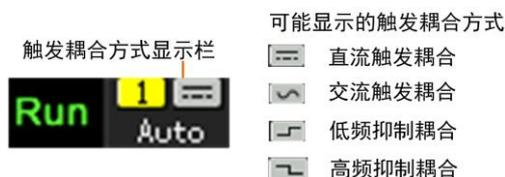
图 2.14 触发耦合方式显示
