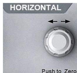
图 2.12 水平时基偏移旋钮
