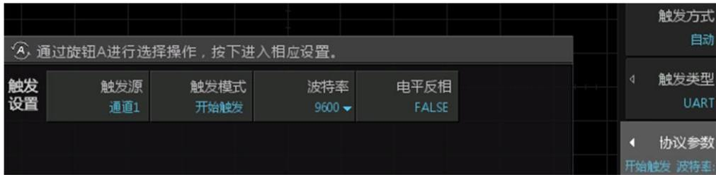
图 6.39 UART 触发协议参数
