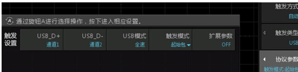
图 6.42 USB 触发协议参数
