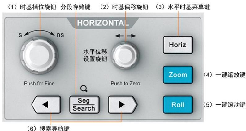
图 2.18 水平控制区（分段存储键暂未开放）
