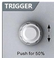
图 2.16 触发偏移旋钮
