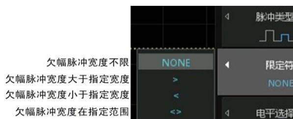
图 6.19 欠幅脉冲宽度限定
