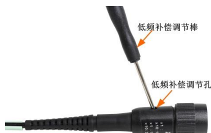
图 5.7 探头补偿调节孔
