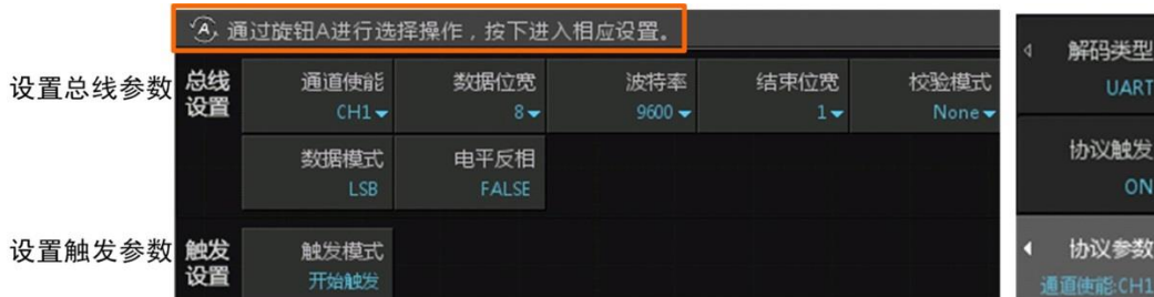
图 15.12 设置协议参数
