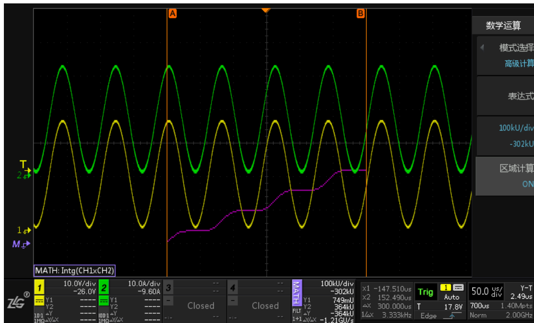
图 18.11 能量损耗的区域运算结果
