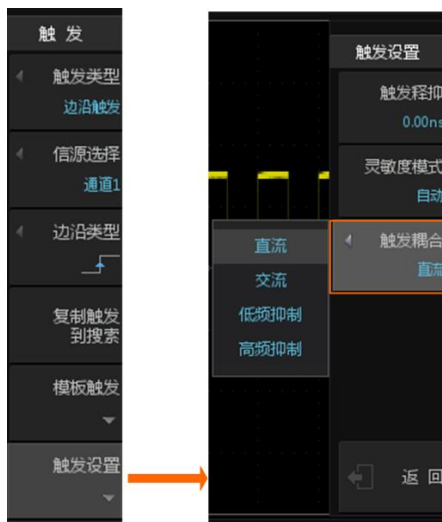
图 10.22 触发耦合设置
