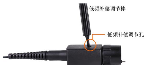
图 5.7 探头补偿调节孔
