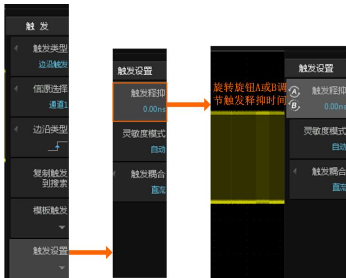
图 10.18 触发释抑界面
