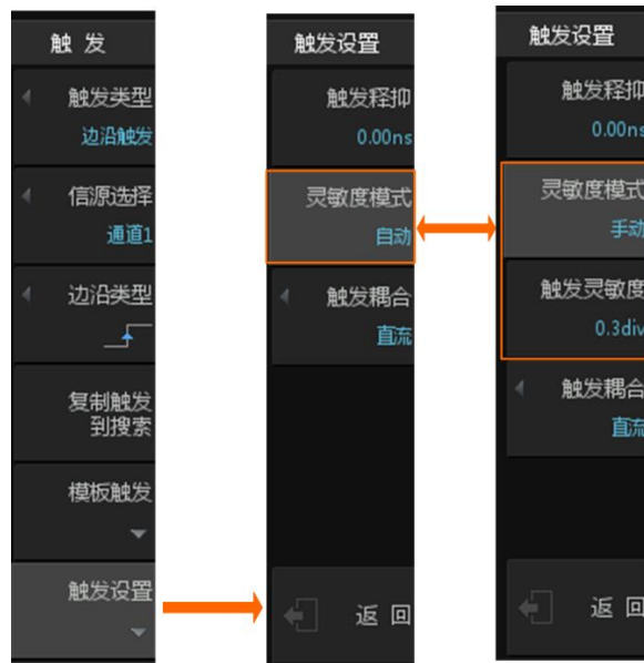
图 10.20 触发灵敏度设置
