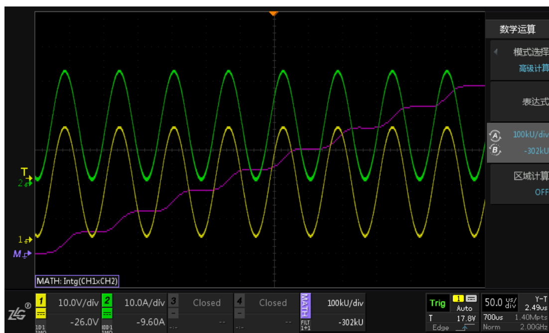
图 18.9 能量损耗运算结果
