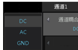
图 9.2 通道耦合设置示例
